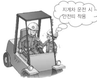
지게차 운전 시 안전띠 착용 (jigecha unjeon si anjeontti chagyong) Wearing a safety belt when driving a forklift
